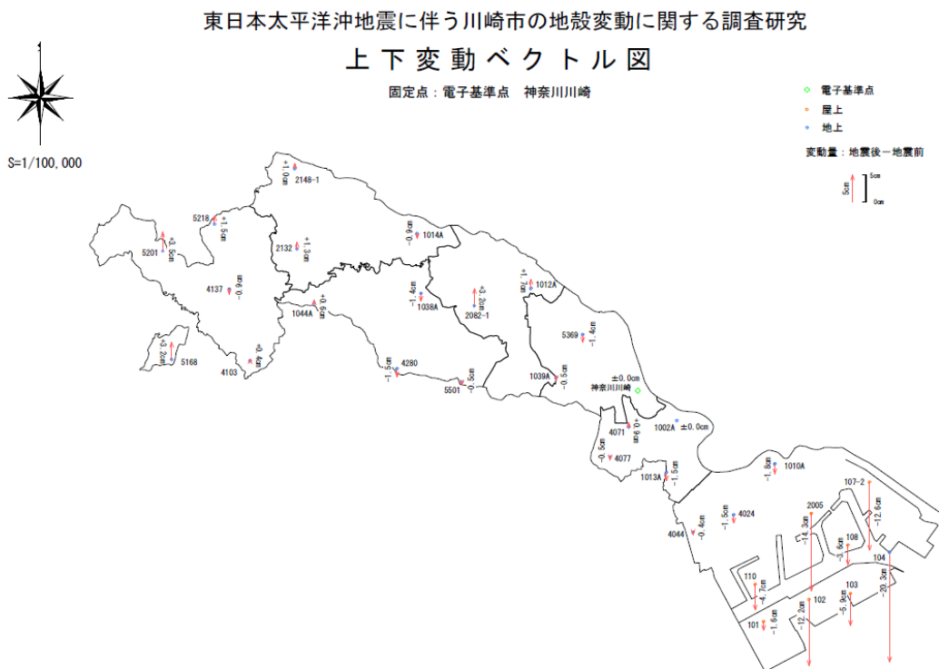
図-4 電子基準点神奈川川崎を既知点とした上下変動ベクトル
