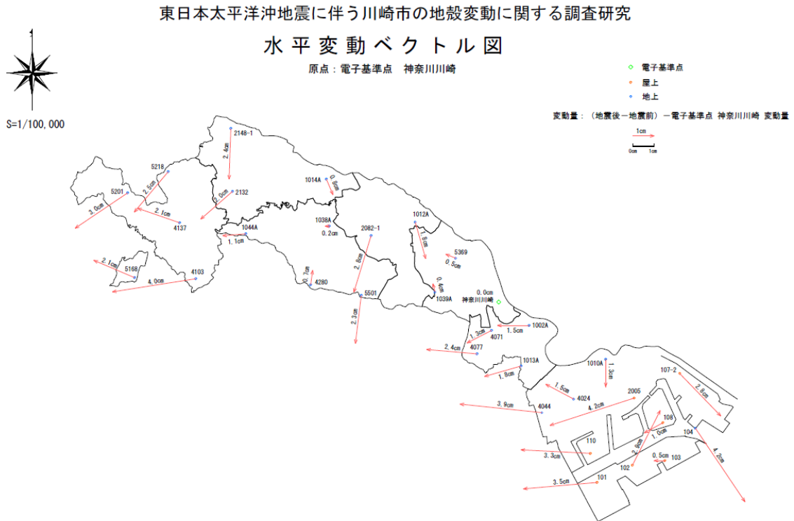
図-3 電子基準点神奈川川崎を既知点とした水平変動ベクトル
